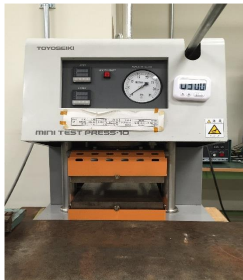
東洋精機 (Mini TEST PRESS-10), 出力: 10 ton, 盤面サイズ: 250×250 mm プラテン加熱冷却, Max. 300°C
