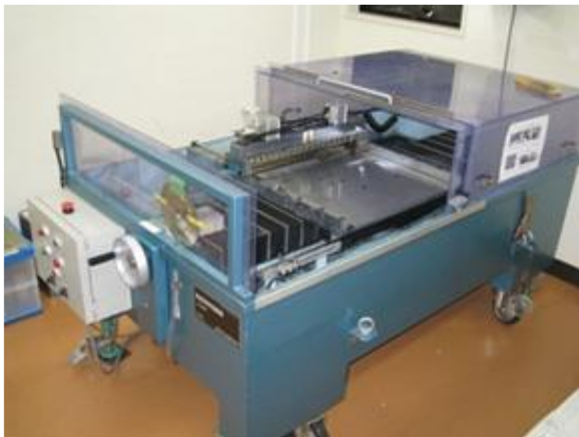
丸東製作所(AC-500CF), 切断能力 :500×500 mm自動送り・戻し機構, エアーシリンダーによるクランプ機
