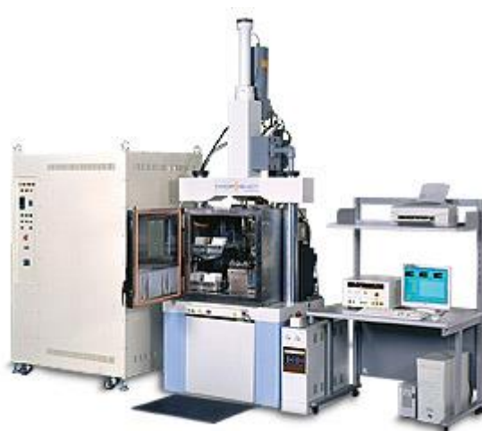
島津製作所 (HITS-P10) 最大衝撃試験力 :10 kN 油圧コントロール式 最高速度 :20 m/s 恒温槽付
