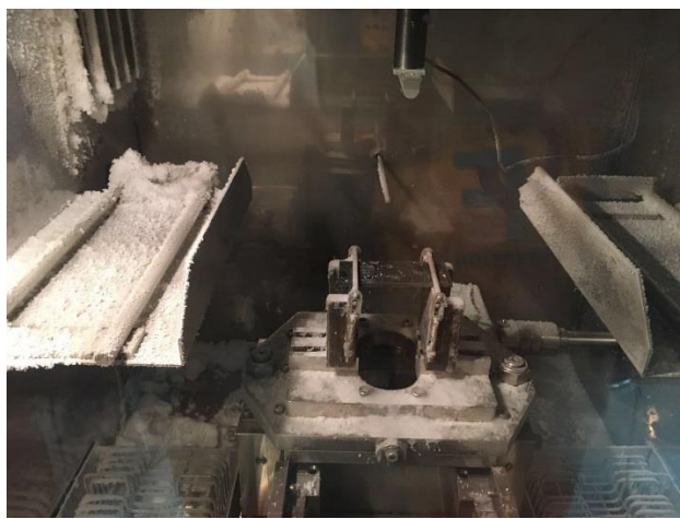
Fig. 3-3 CTT の 3 点曲げ衝撃試験におけるセッティング (-30°C)
