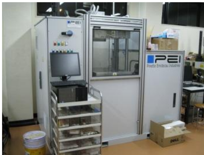
複動加熱冷却自動プレス 出力 :30 ton 盤面サイズ :500 mm 1 プラテン加熱冷却 温度精 度, 200°C :R4.3°C, 400°C :R7.5°C 熱盤 9 分割独立制御 プログラム自動運転
