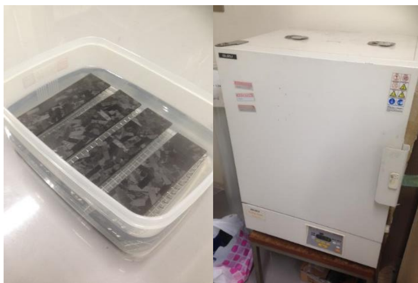
Fig. 2-8 吸水試験の装置
