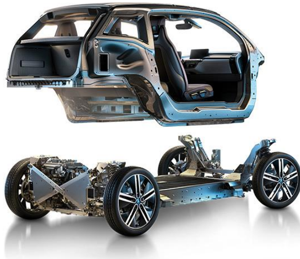
Fig. 1-13 BMW 「i3」の車体構造, 上車体:CFRP, 下車体:アルミニウム合金[34]
