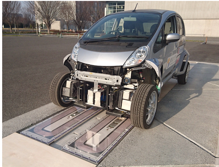
図 191: 第2世代ワイレスインホイールモータを搭載した FPEV4-Sawyer
