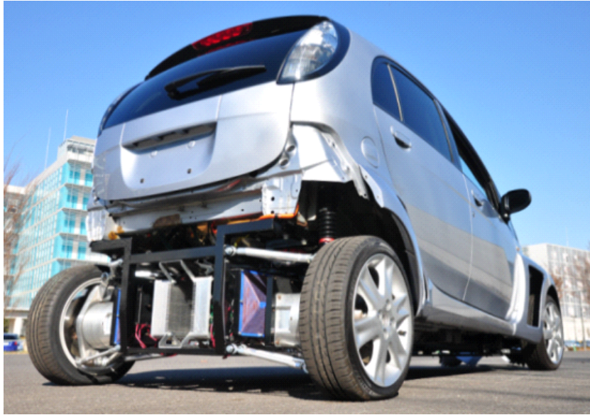
図 146: 第 1 世代ワイヤレスインホイールモータを搭載した FPEV4-Sawyer
