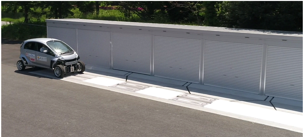
図 190: 走行中ワイヤレス給電システムの全体像
