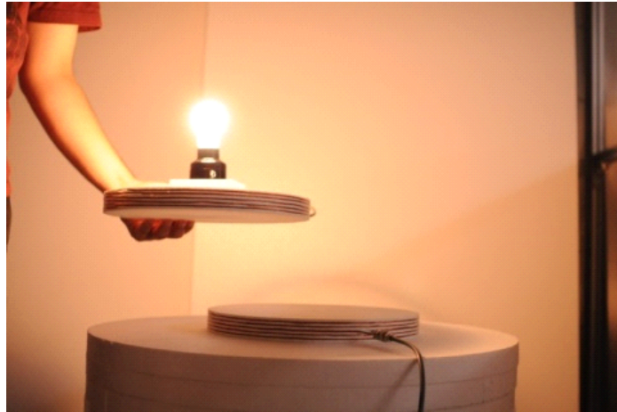
図 28: 磁界共振結合によるワイヤレス電力伝送
