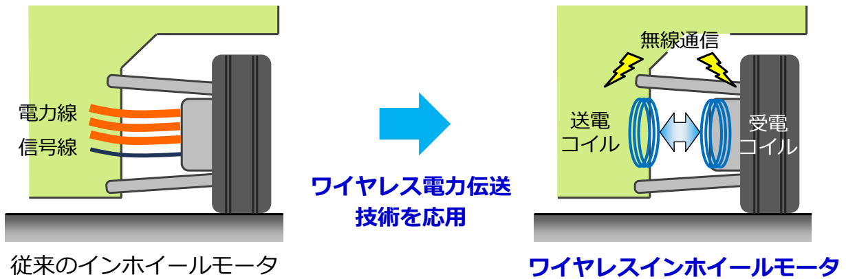
図 119: 第 1 世代ワイヤレスインホイールモータのコンセプト
