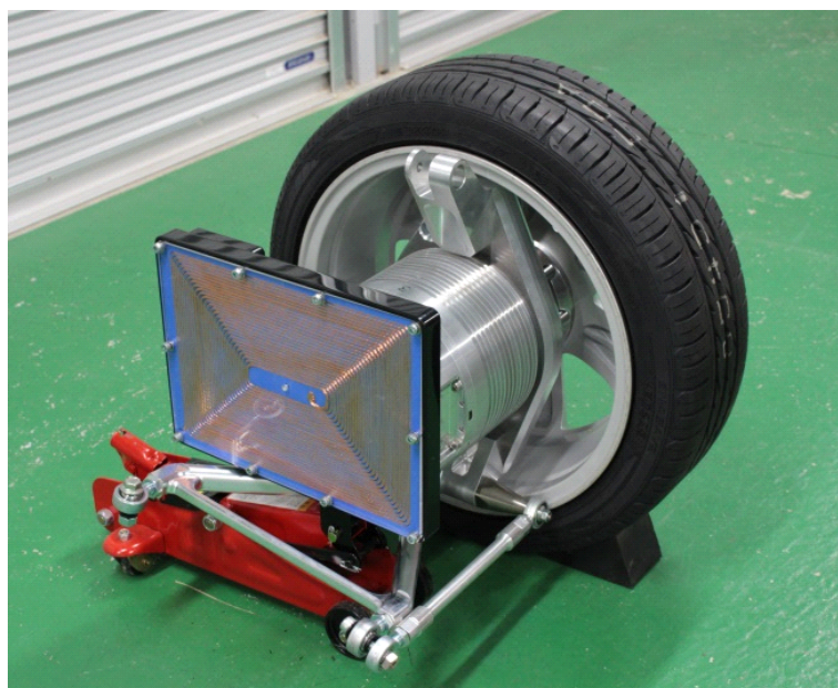
図 122: 受電コイルを搭載した第1世代ワイヤレスインホイールモータ
