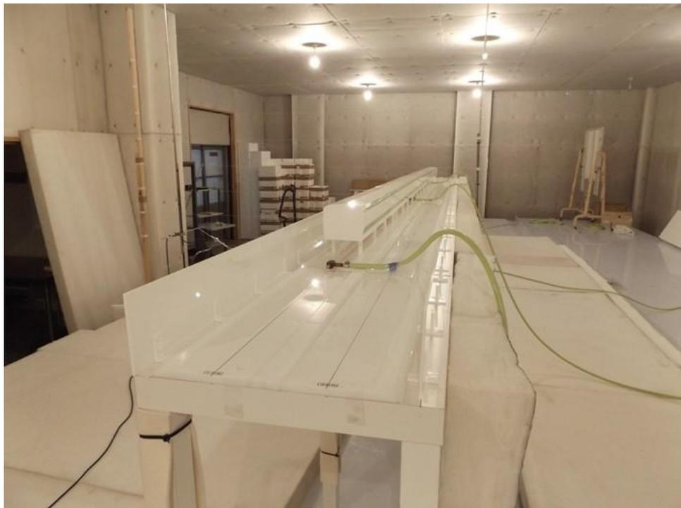
図 4.10 高架橋の軌道，列車の設置状況
