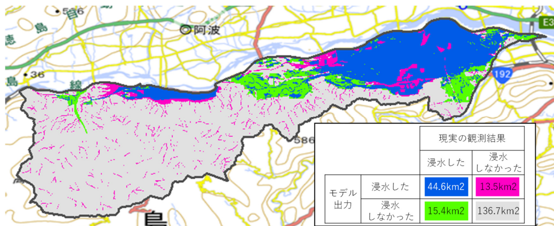
図 4-25 2004年10月台風23号の浸水計算キャリブレーション結果
