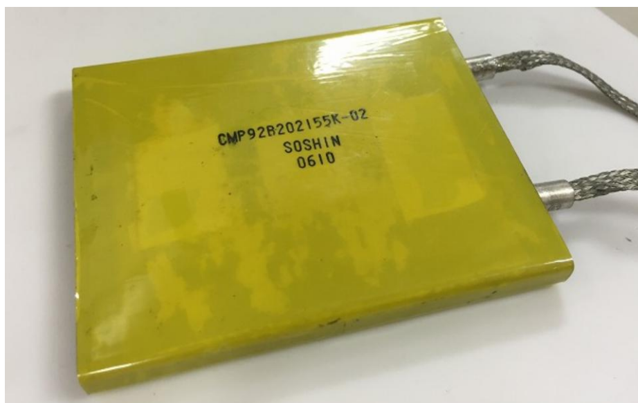
Figure 3.4 主放電キャパシタ (CMP92B202155K-02)
