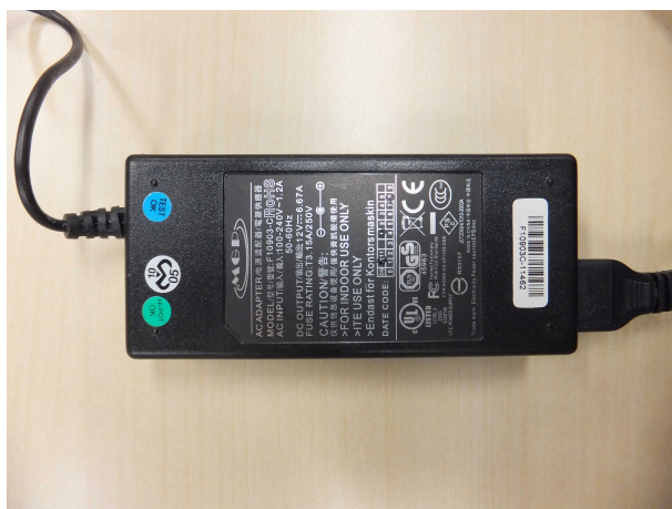
図 2.3 PFC コンバータが搭載された AC アダプタ
