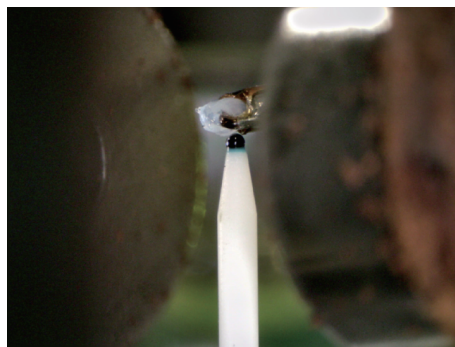
図 5.2: 磁気回路のギャップ中心に設置された直径 0.5 mm の球状 YIG 単結晶サンプル。白いアルミナ製ロッドに接着され固定されている。YIG サンプル直上に見えるのが一巻きコイル。コイルに付属する半透明の物質は、同軸線に含まれる絶縁体部分である。YIG サンプルの左右にはネオジム磁石が見える。写真手前で赤く見えているのは磁気回路を構成する純鉄製の継鉄 (ヨーク) についている赤錆。表面にテフロン加工を施しているが、長期間にわたる実験の末、錆てしまっている。
