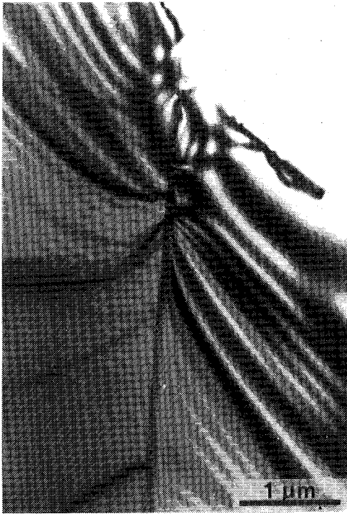
写真3 111 共通反射により撮影された \Sigma 7 対応粒界の弱ビーム暗視野像
