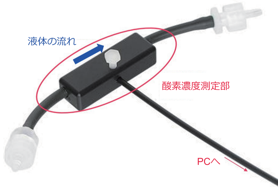
図 3.6 使用した蛍光式酸素センサ。センサ内に溶液を流している状態で酸素濃度を測定する。
