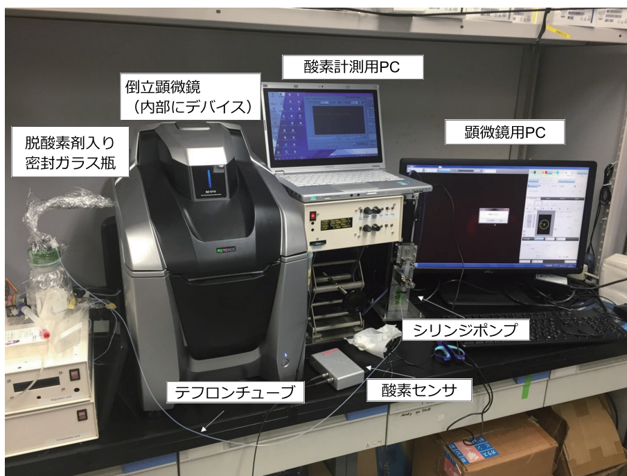
図 3.17 蛍光輝度評価実験セットアップ。
