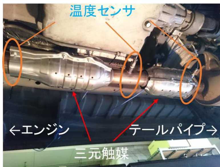
図 3-4 三元触媒と温度センサ
