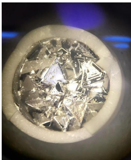
図 57 フラックス除去後のるつぼの様子。 ピラミッド状の結晶が \text{PrV}_2\text{Al}_{20}
