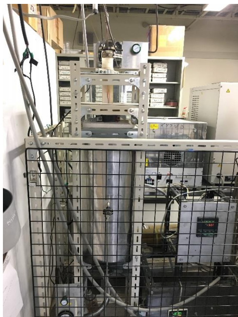
図 43 合成に使用した縦型真空炉
