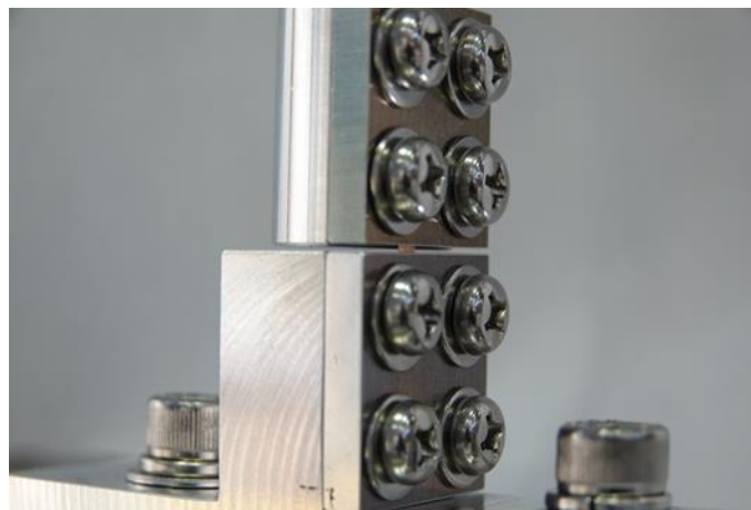
図 3.3 L = 1 \text{ mm} での実際の圧縮試験の様子
