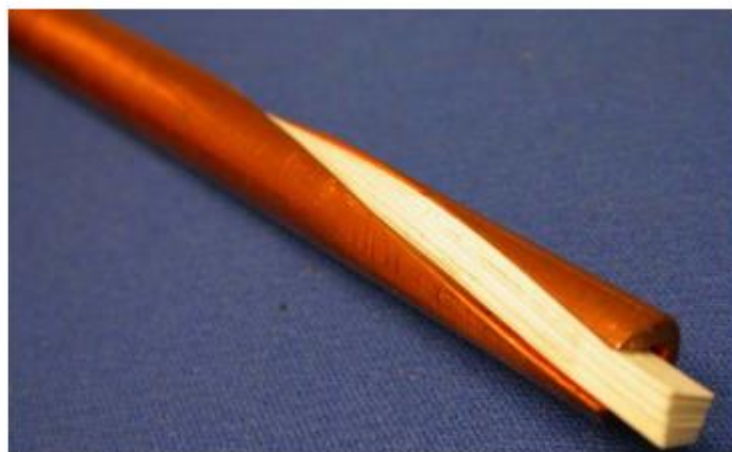
図 1.2 TSTC 導体の外観図。ツイストした REBCO テープを積層している[5]
