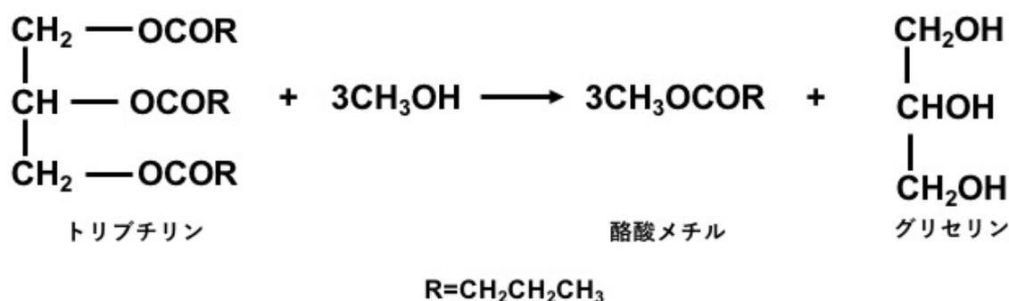
Fig.10 トリブチリンのエステル交換反応式
