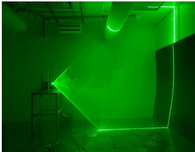
図 2-1 レーザー照射による気流可視化の一例
