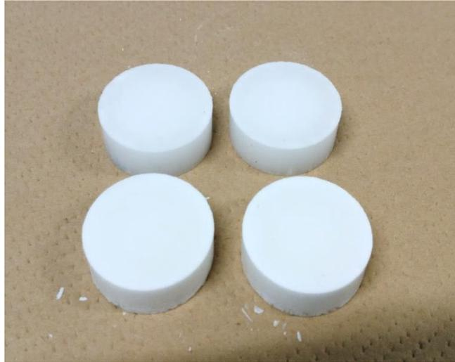
図 3.10 粒径別の塩化カリウム線源(上 2 つ : 150  $\mu\text{m}$  以上 300  $\mu\text{m}$  未満、下 2 つ : 300  $\mu\text{m}$  以上)
