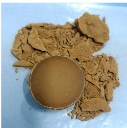
図 3.5 圧縮時に割れたインスタントコーヒー線源
