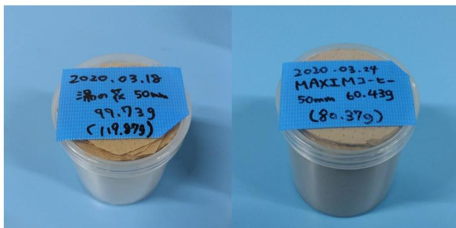
図 3.13 Ge 半導体検出器での測定試料(左：湯の花、右：インスタントコーヒー)
