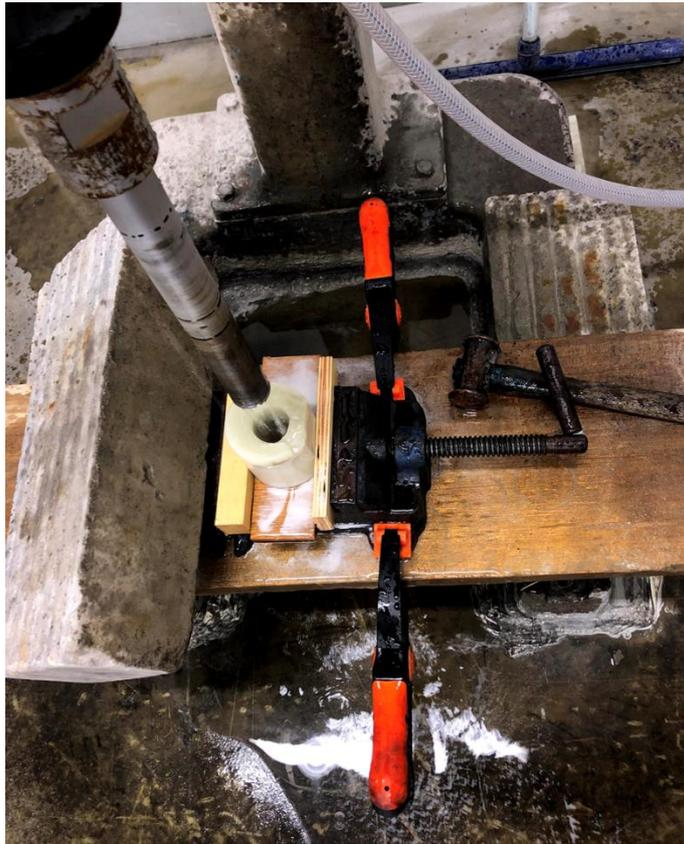
図 3-9 ボーリングマシンによる Sandstone analogs の成型過程（くり抜き後）
