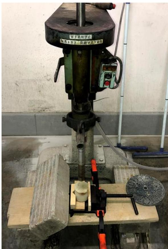
図 3-8 ボーリングマシンによる Sandstone analogs の成型過程（くり抜き前）
