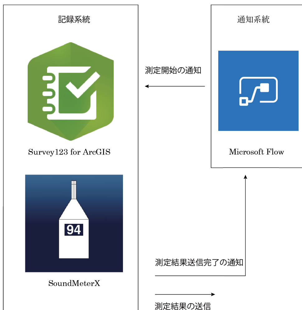
図 11: 記録システムの構成図
