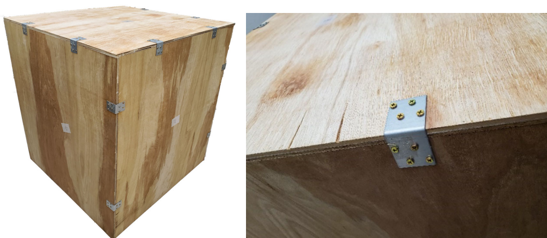
図 2-7 コンパネの面材間の固定の様子(左：左後方からの様子、右：固定部分)
