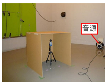
図 3 残響室における(b)の測定風景
