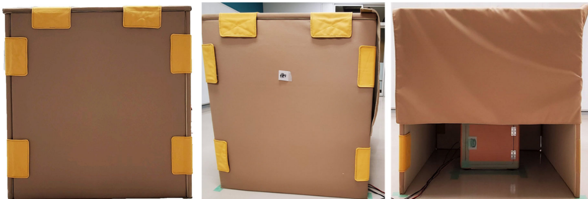
図 2-9 NPHP の固定の様子（左から背面、カーテンありの側面、カーテンありの正面）
