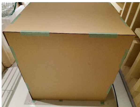
図 2-5 段ボールの面材間の固定の様子 (後方の様子)
