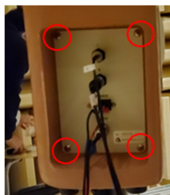
図 4-8 ダミーヘッド側面のケーブル接続板の様子
