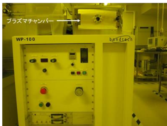
図 2-8 プラズマ照射装置（WP-100、bondtech 社製）
