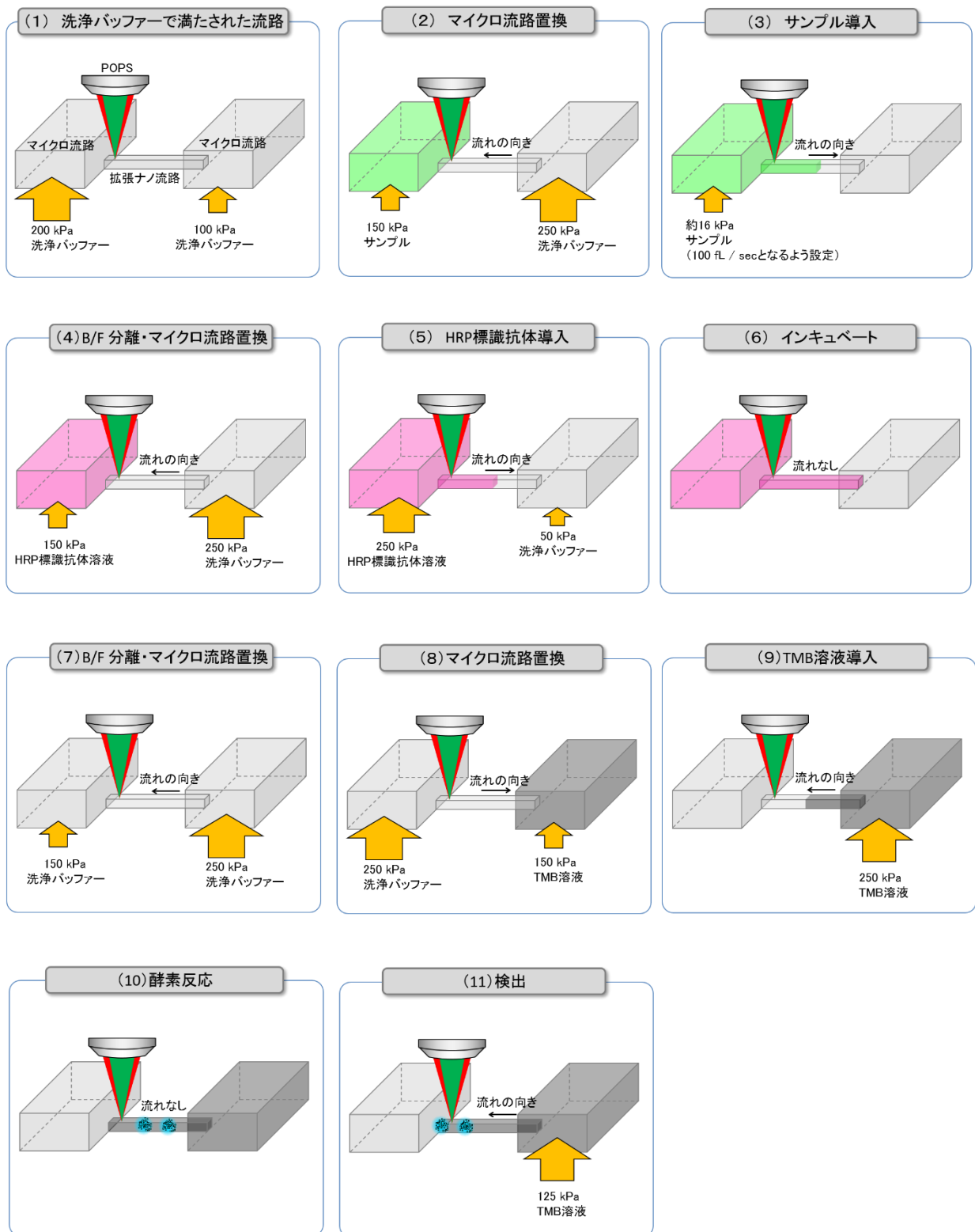
図 2-21 ELISA の流体操作プロトコール
