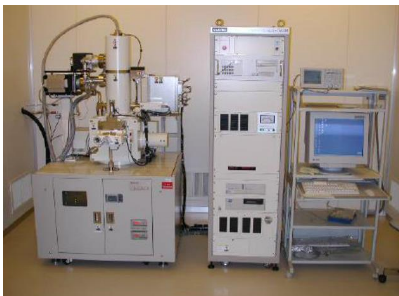
図 A-2 電子線描画装置（ELS7500、エリオニクス社製）
