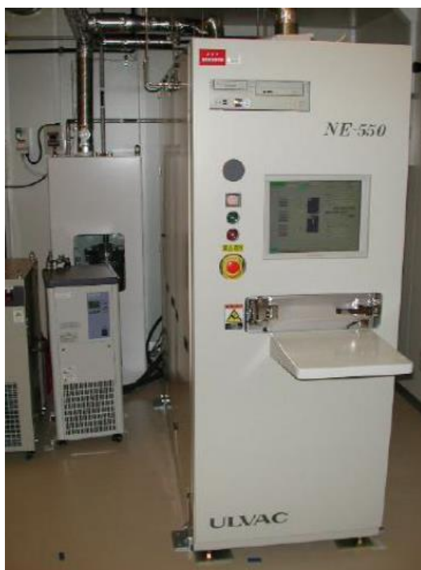
図 A-3 プラズマ装置（NE-550、ULVAC 社製）
