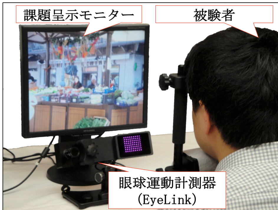
図 5. 眼球運動計測器の設置例
