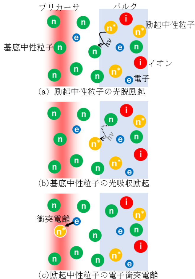
図 4-2 輻射による励起中性粒子の輸送 (a)励起中性粒子が光脱励起を起こし(b)できた光子が別の基底中性粒子に再吸収されて励起が起きる (c)この過程を繰り返してプリカーサに到達した励起中性粒子が電子と衝突して電離する
