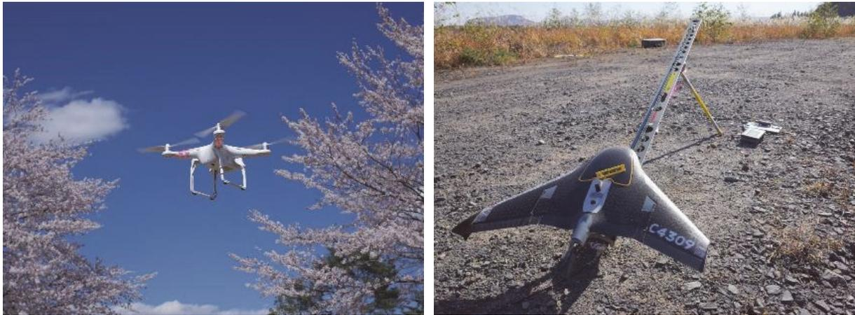
図 2.2 回転翼 UAV および固定翼 UAV の例
