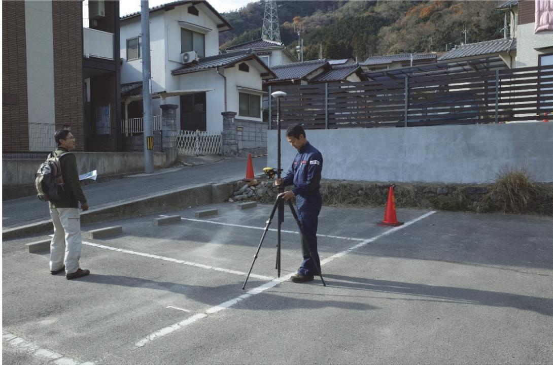
図 2.7 GNSS による地上基準点測量の例
