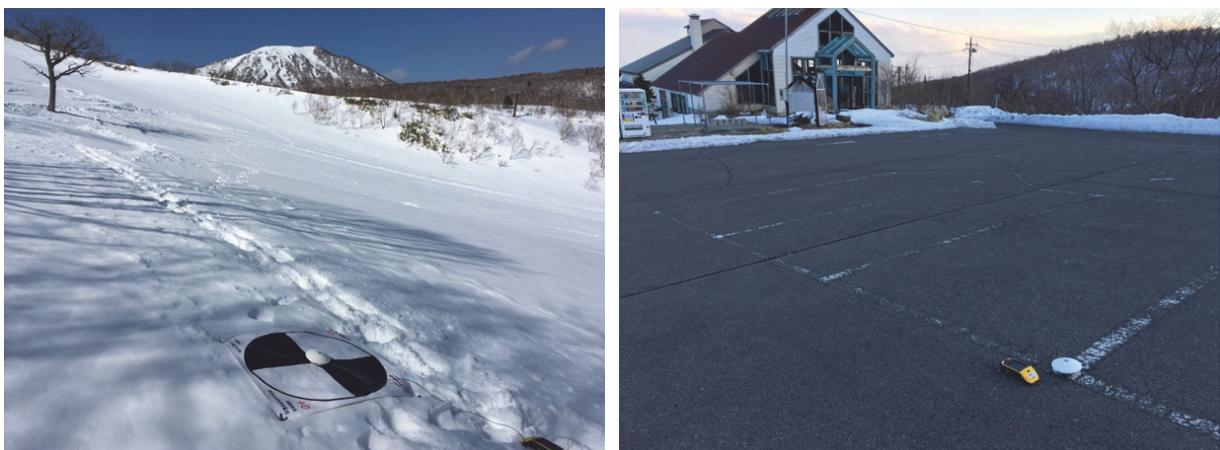
**図 2.6** フィールド上の地上基準点の例
