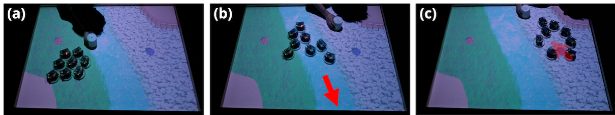
図 4.40: サンプルゲームアプリケーションの様子。プレイヤーはコントローラとなる円柱状の物体を操作し、ロボットをスタートエリア (ゲームフィールドの左下隅) からゴールエリア (フィールドの右上隅) に誘導する。(a) 通常のフィールドでは、ロボットはコントローラの方向に移動する。(b) 川となっているフィールドでは、ロボットはコントローラの方向に向かうが、同時に川の流れに流される。(c) フィールド上に敵キャラクターがいる場合、ロボットは敵を避けながらコントローラの方向に移動する。
