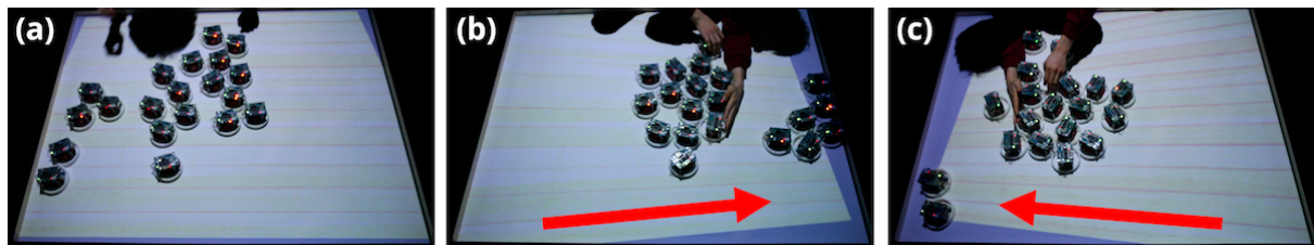
図 4.39: シーソーを模したアプリケーションの様子。バーチャルなシーソーの模様と平行な方向にシーソーは傾き、ユーザーがシーソー板を傾けると、群ロボットは斜面を滑り降りるように動作する。(a) シーソー板が平行になっている状態で、ロボットはその場に留まる。(b) シーソー板が右に傾いている状態で、ロボットは傾きに応じて右方向に動作する。(c) シーソー板が左に傾いている状態で、ロボットは左方向に動作する。
