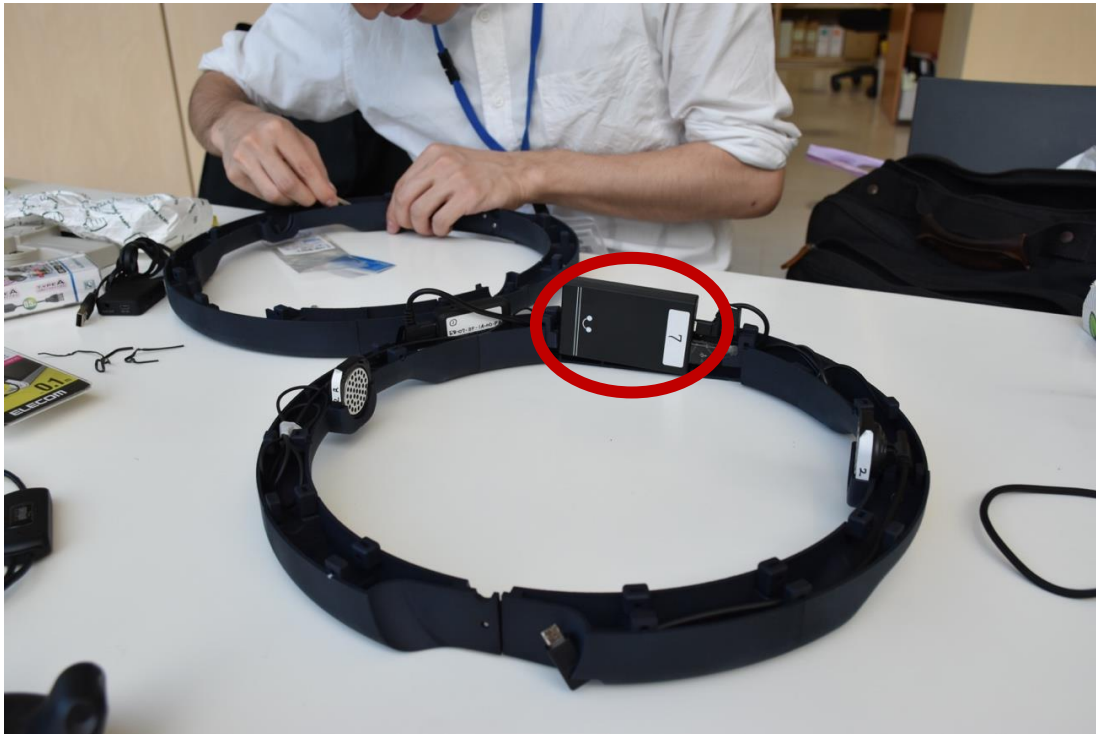
分解された Sight. 赤枠はモバイルバッテリーを示す.
