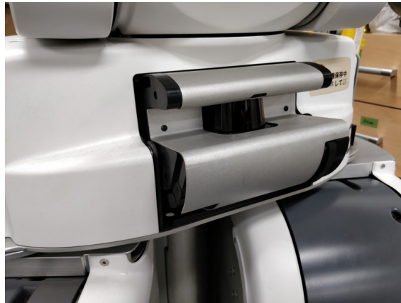
図 3.5: ロボット胸部に取り付けられた回転機構を伴うレーザーレンジファインダ
