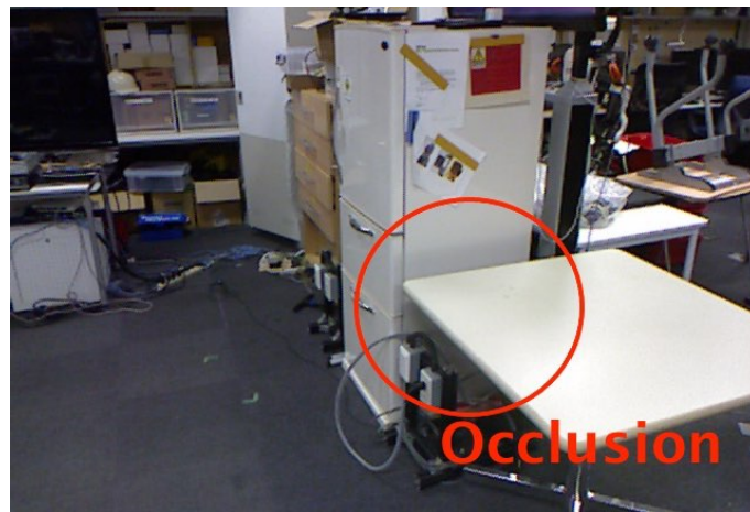
図 5.17: 2次元画像における定位置操作物体認識器学習データセットの自動生成時に発生するオクルージョン ([98] より引用)
