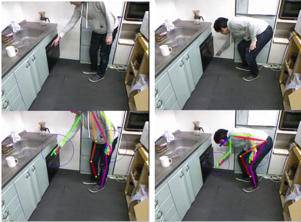
(a) 操作対象手前左上隅位置の認識．上はカメラセンサから得られる画像．下は入力画像を Openpose モデルに入力して推定された人の関節モデルの位置と関係を入力画像上に頂上表示したもの
