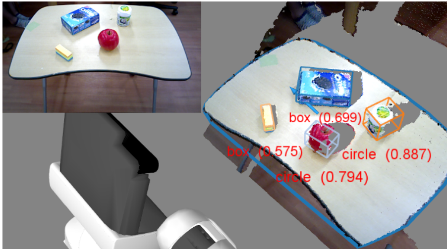
図 7.2: 物体基本形状検出器を用いた物体の性質認識 ([138] から引用)
