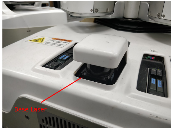
図 3.4: ロボット台車部に取り付けられたレーザーレンジファインダ
