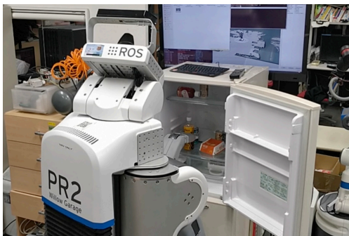
(e) 冷蔵庫内の物体支持平面を認識し、冷蔵庫内にペットボトルを置く
