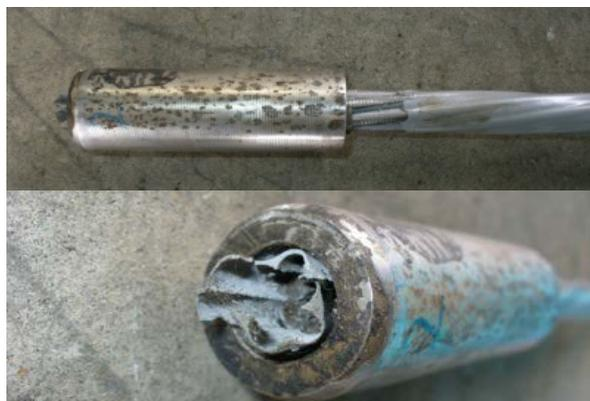
写真-5.6 エポキシ樹脂被覆 PC 鋼材が圧着部で抜けた状態
