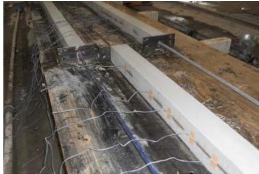
写真-5.4 導入力伝達長測定状況
