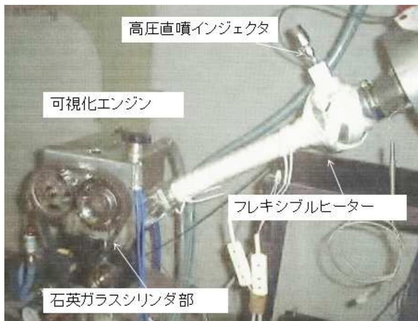
図 3.12 均一混合気生成部の構造 (拡大)
