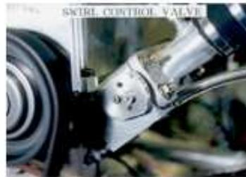
図3.7 スワールコントロールバルブ SCV (手動)
