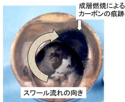
図 3.30 スワール流動によるピストン頂面へのカーボン付着
