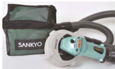
図 2-5 試料の切削回収に用いた集じん機付属のグラインダー
