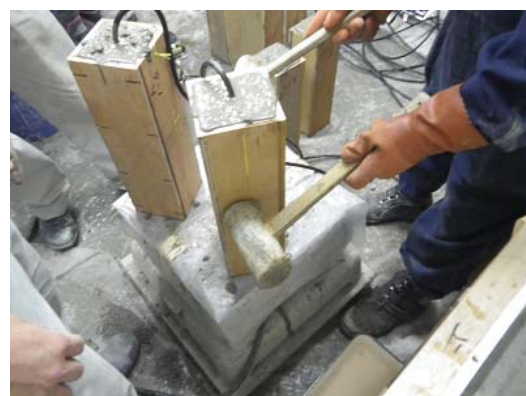
写真 4.3.1 W キュアリング供試体の型枠と供試体の作製状況
