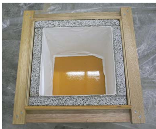
写真 3.2.1 試作した型枠構造（透水性のモルタル板を使用）
