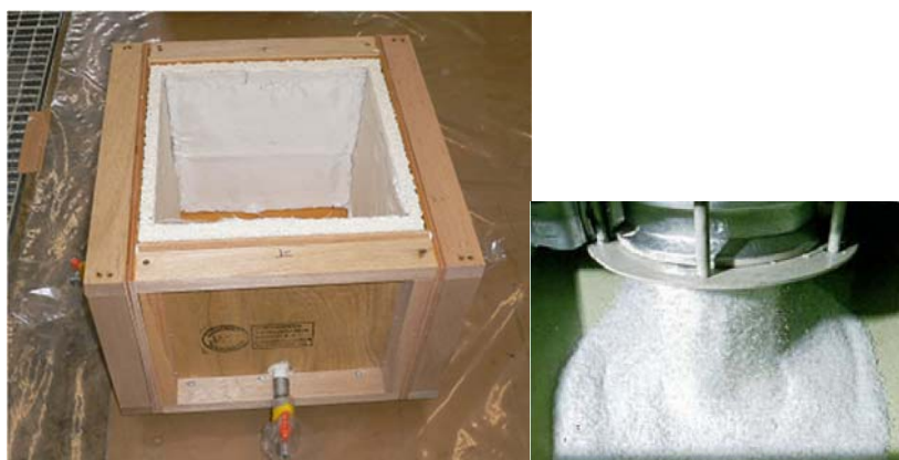
写真 3.2.2 試作した型枠構造（発泡スチロールのリサイクル材を使用）
