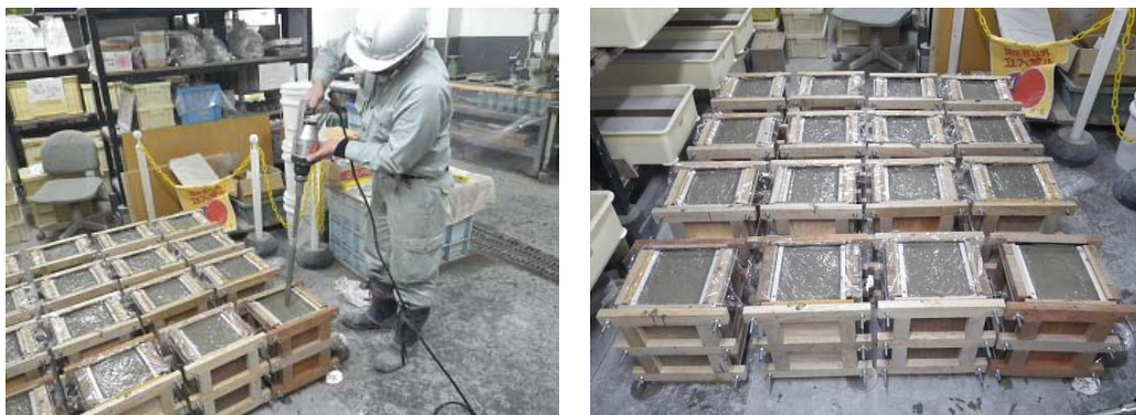
写真 3.4.1 供試体の型枠と供試体の作製状況
