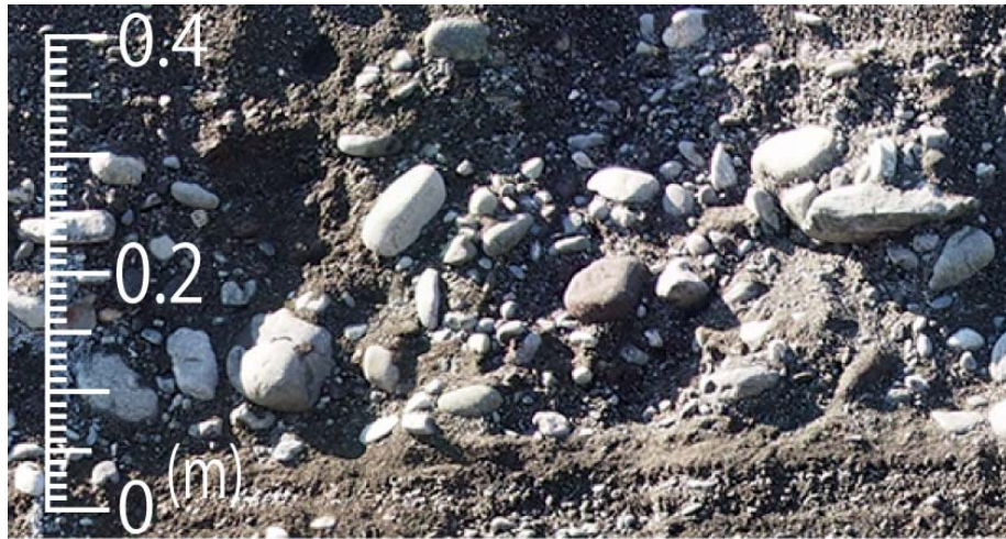
写真-2.3.14 無指向な混合状態(No.43,x=81m,z=3.0m, 2015 年 2 月 5 日)
