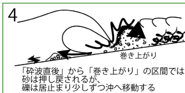
図-3.9.4 堆積状況と礫の移動形態の関係
