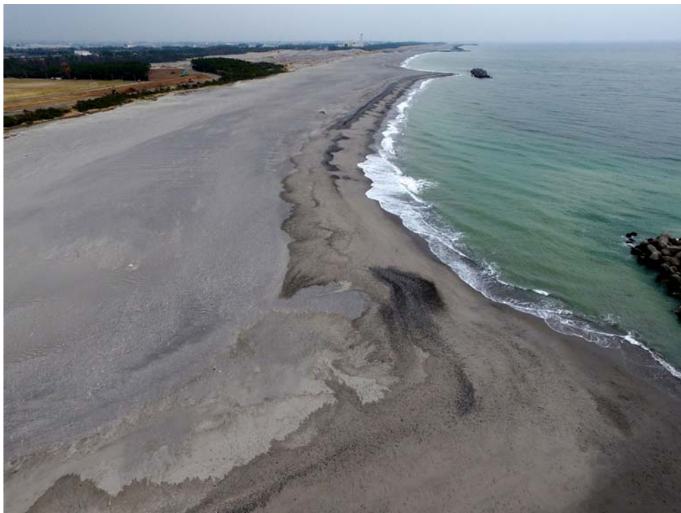
写真-2.4.8 2号離岸堤から東側の礫の堆砂状況（2017年3月31日）
