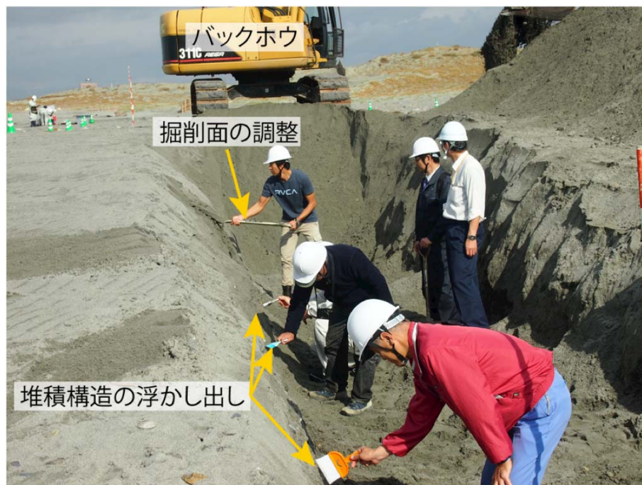
写真-2.1.2 掘削露出面の調整（2015年11月17日浜松篠原 No.161）
