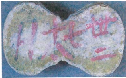
S-1-1 明治32年作製，海水保存 (北海道セメント1：試験砂2)
