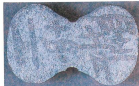
A-4-1 明治42年作製，気中保存 (北海道セメント1：試験砂3)
