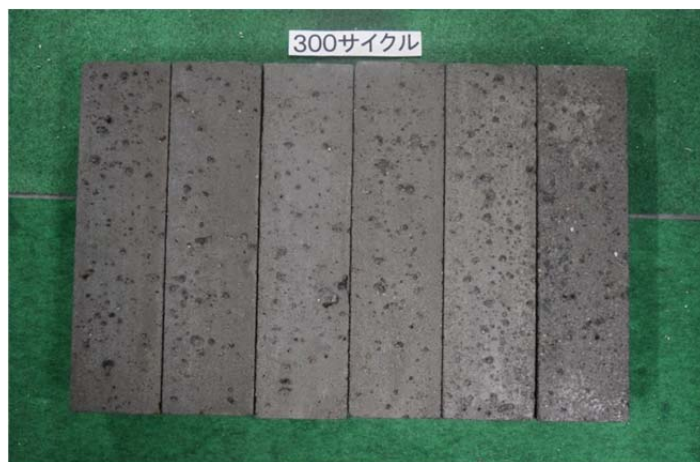
写真 4.3.2 HC+SF 供試体の 300 サイクル終了後の外観状況
