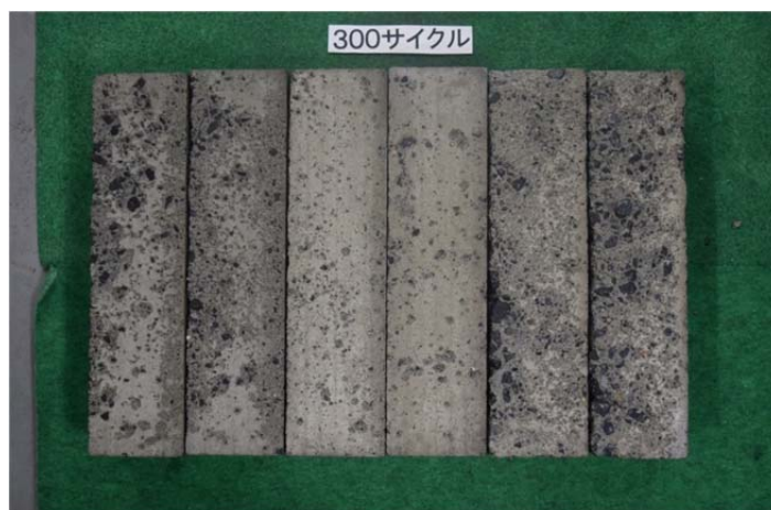
写真 4.3.1 HC 供試体の 300 サイクル終了後の外観状況
