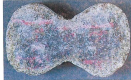
W-2-2 明治42年作製，淡水保存 (北海道セメント0.8：小樽火山灰0.2：試験砂3)
