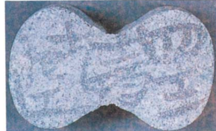
A-1-5 明治42年作製，気中保存 (北海道セメント0.8：小樽火山灰0.2：試験砂3)
