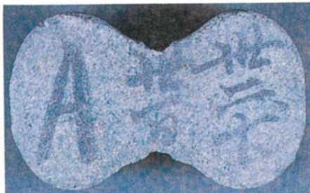
A-5-2 明治32年作製，気中保存 (浅野セメント1：試験砂2)
