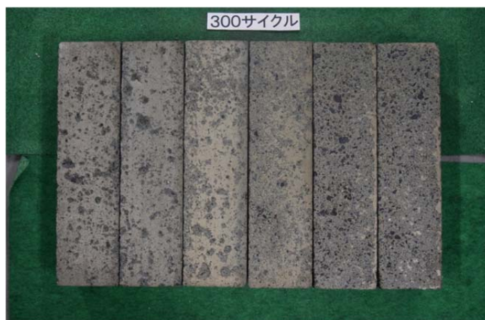
写真 4.3.3 HC+BFS 供試体の 300 サイクル終了後の外観状況
