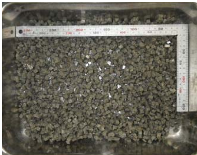
写真 3.1.1 5mm 角のモルタル供試体
