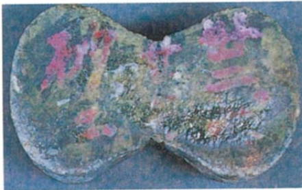
S-1-2 明治32年作製，海水保存 (浅野セメント1：試験砂2)
