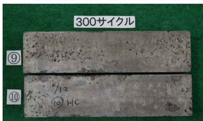
写真 5.3.2 凍結融解 300 サイクル後の外観状況 (表面含浸材有、乾湿繰返し)
