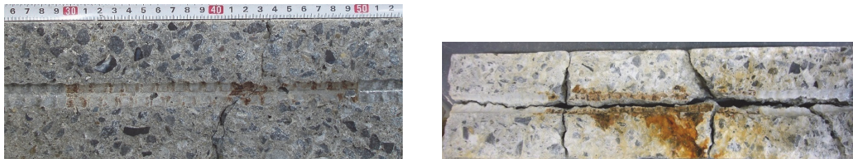
図 D-12 電食試験後のコンクリートの状況
