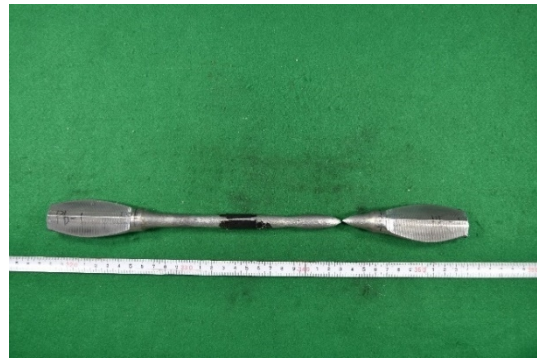
写真 試験後 (1mm/min)
