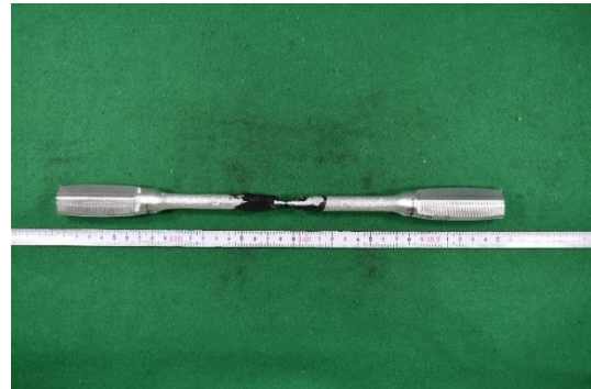
写真 試験後 (100mm/min)
