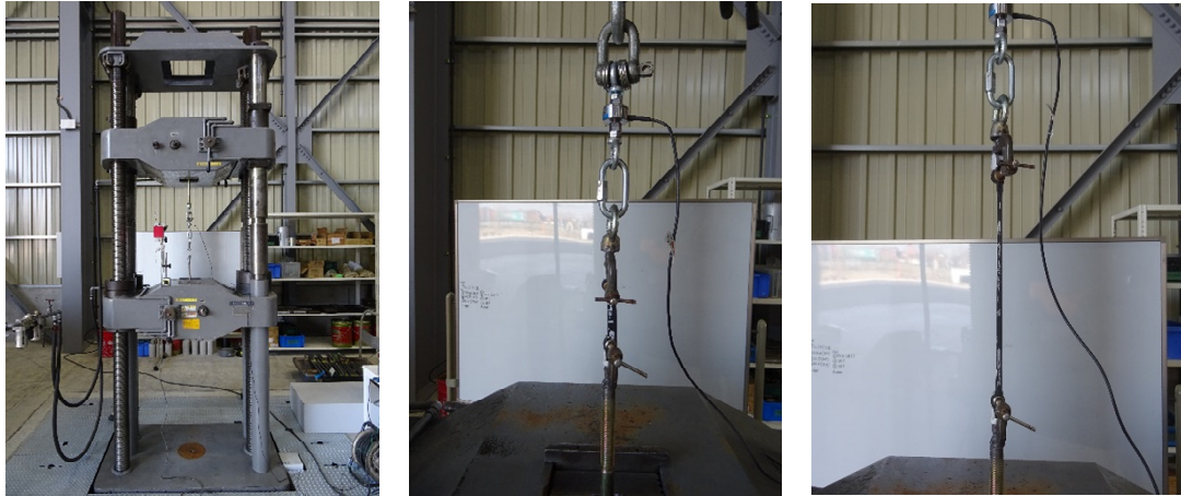
図 4.3.1 JIS に準じた一軸引張試験の状況 (U90)
