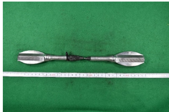
写真 試験後 (10mm/min)
