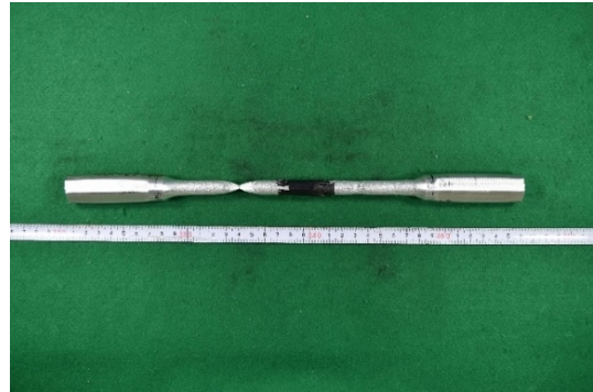
写真 試験後 (1mm/min)
