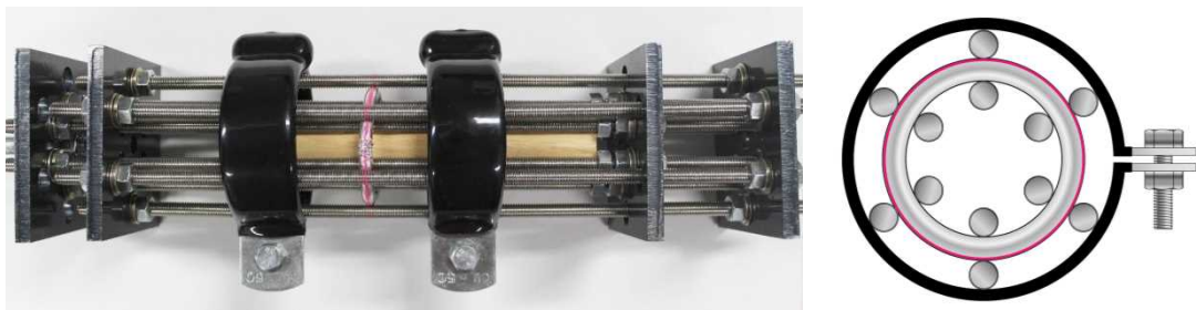
図 5.1.1 錫・鉛を用いた円環ダンパーの構成（噛合い型）
