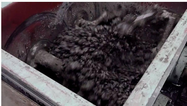
Photo6.2.3 RJC のモルタル練混ぜ開始 90 秒後
