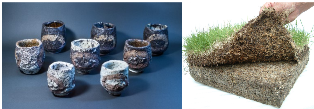
Fig. 3.5.24 粘土質分を用いた陶器と軽石を用いた緑化基盤
