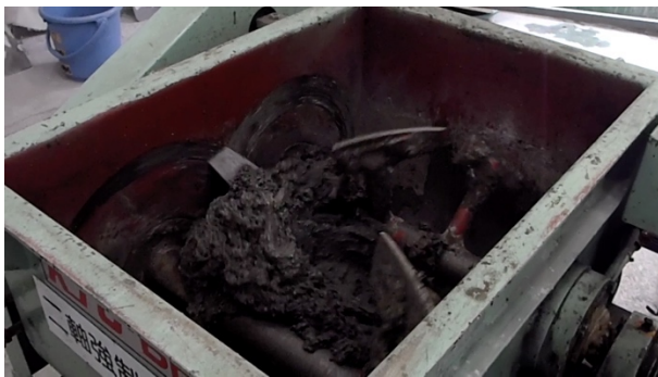
Photo6.2.1 SF のモルタル練混ぜ開始 90 秒後
