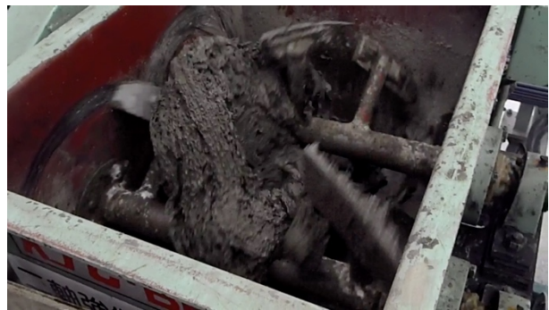
Photo6.2.2 RJF のモルタル練混ぜ開始 90 秒後
