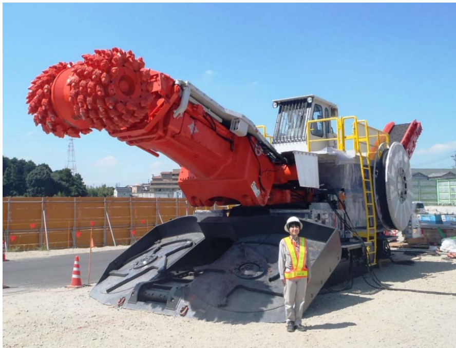
図3-8 拡幅掘削として当初計画されていた自由断面掘削機MT720（サンドビック社製）
