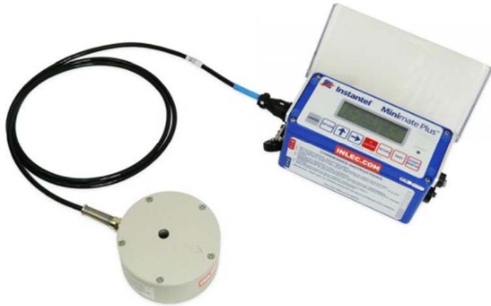
図3-23 3成分振動速度計(Instantel社製 Minimate Plus)
