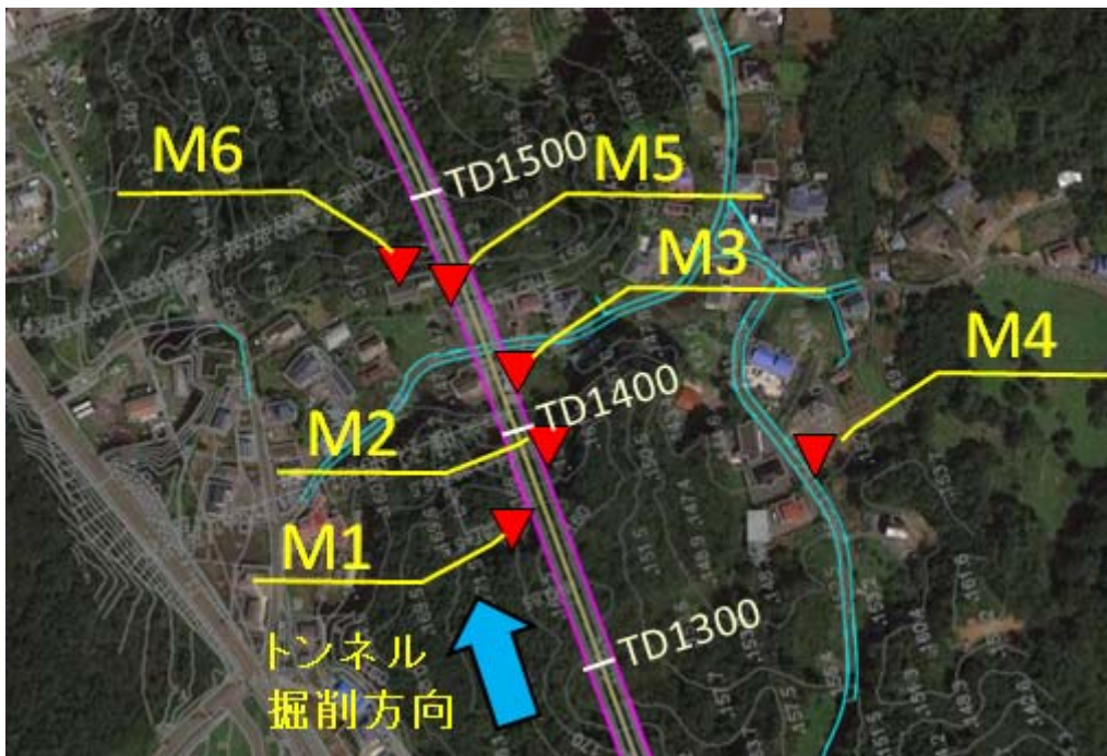
図 5-15 発破振動の計測点(M1～M6)
