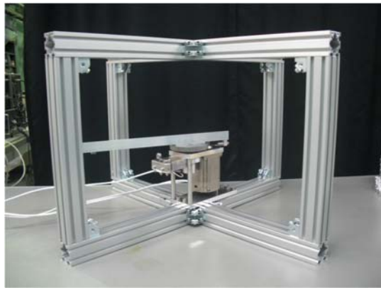
図 A.1-30 取付部試験概念図（上）および試験装置（下） 振り子運動試験（左）と円錐運動試験（右）[106]
