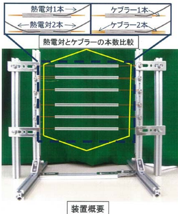
図 A.1-15 真空チャンバ内模擬太陽光照射試験の試験片[96]
