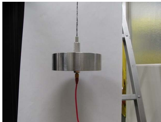
図 A.1-8 テザーに吊るした錘および錘に付けられた加速度計[87]
