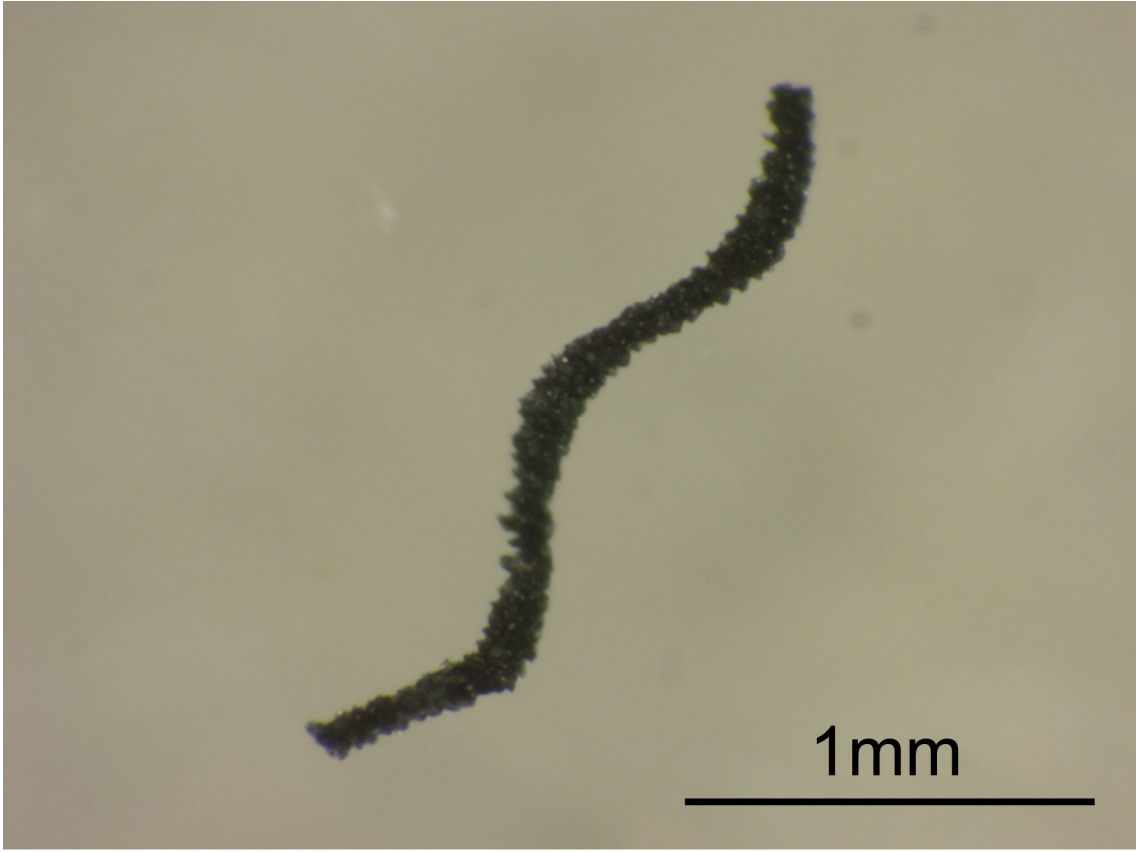
図 5.1 造形した磁気マイクロマシン。スケールバーは 1 (mm)である。
