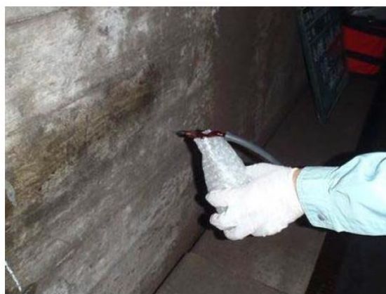
写真 5-2-1 硝酸銀溶液の噴霧状況
