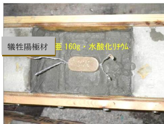
写真 6-2-5 供試体（犠牲陽極材設置状況）
