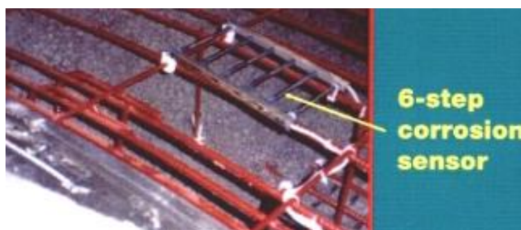
写真 2-3-4 セグメント鉄筋腐食センサー 38)
