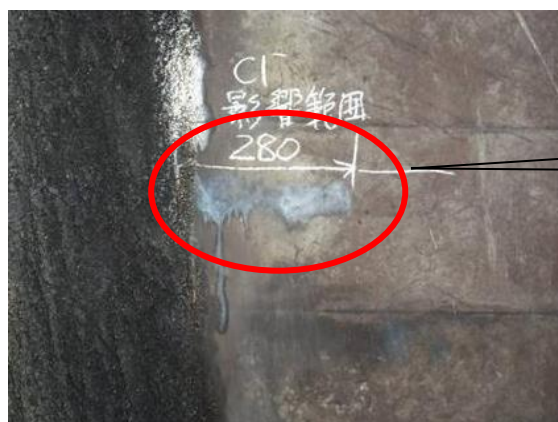
写真 5-2-2 硝酸銀溶液噴霧による発色状況
