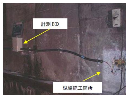
写真 6-2-3 犠牲陽極材の効果確認の試験状況（東西線 亀島川下）
