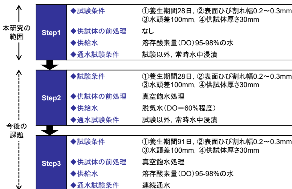
図 4.2-19 自己治癒効果の試験方法確立に向けて
