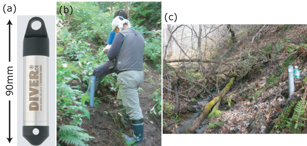
図 11: (a) ダイバー水位計。下の穴の内部に圧力計が露出している。上部の穴は水位計をワイヤーで吊るす時に用いる。(b) 浅間牧場 FRM における水位計設置のようす。塩ビパイプで作成した浅井戸に、ワイヤーで吊るした水位計を挿入する場面。手前に写っているのは東京大学大学院工学系研究科・茂木勝郎氏。(c) 千ヶ滝源泉 SEN の浅井戸（右側）。写真奥が上流。
