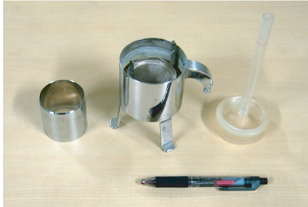
図 44: 透水試験器。試料円筒(左)内に土壌を採取し、円筒上部にアダプター(右)を取り付け、試験器本体(中央)に載せて水を注入することで、飽和透水係数 k_0 を計測することができる。産業技術総合研究所・安原正也氏提供。
