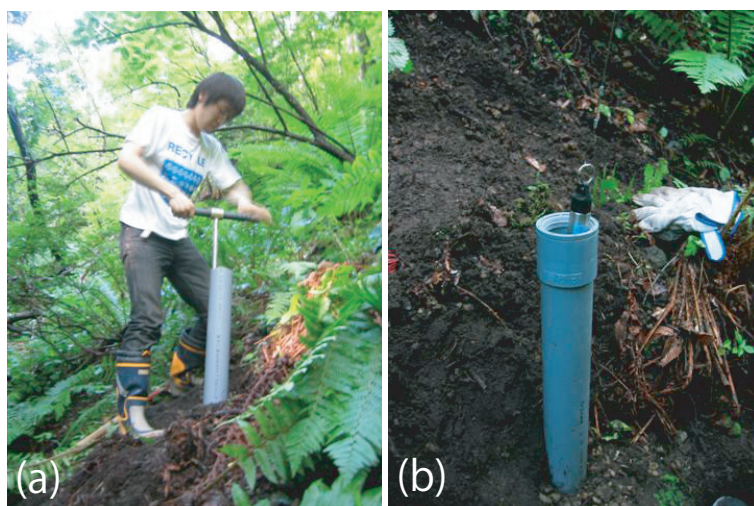
図 4.4: SEN 観測点における浅井戸の設置。(a) ハンドオーガーによる観測孔の掘削。太い径の塩化ビニールパイプをケーシングとして使用した。(b) 塩化ビニール製浅井戸への水位計の挿入。降水の直接浸入を防ぐためにこの後井戸に蓋を取り付けた。
