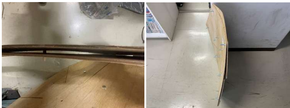
図 65 板を圧着できないダボ（左）、ボルトが表出した曲面（右）
