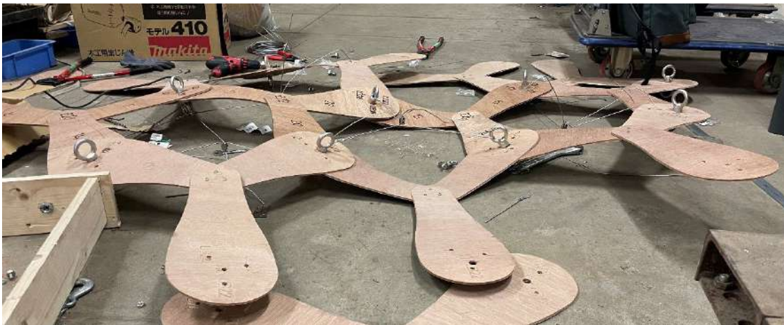
図 76 1/1 モックアップ制作による接合部の検討
