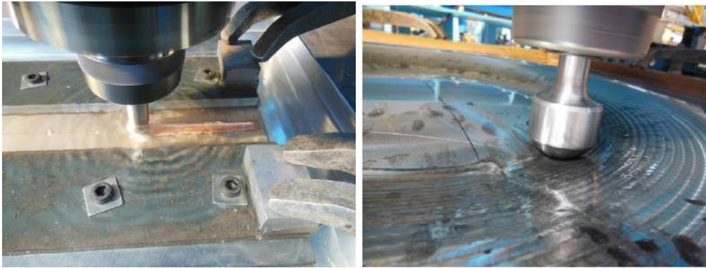
図 42 FWS（摩擦攪拌接合） 123 、インクリメンタルフォーミング 124
