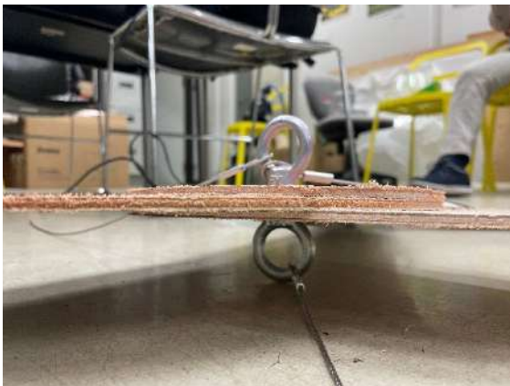
図 77 ユニット間の接合部（アイボルト+アイナット）
