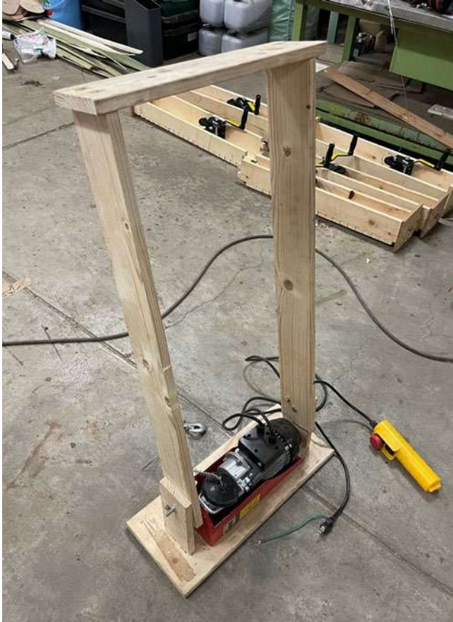
図 121 電動のワイヤー巻き取り機の試作
