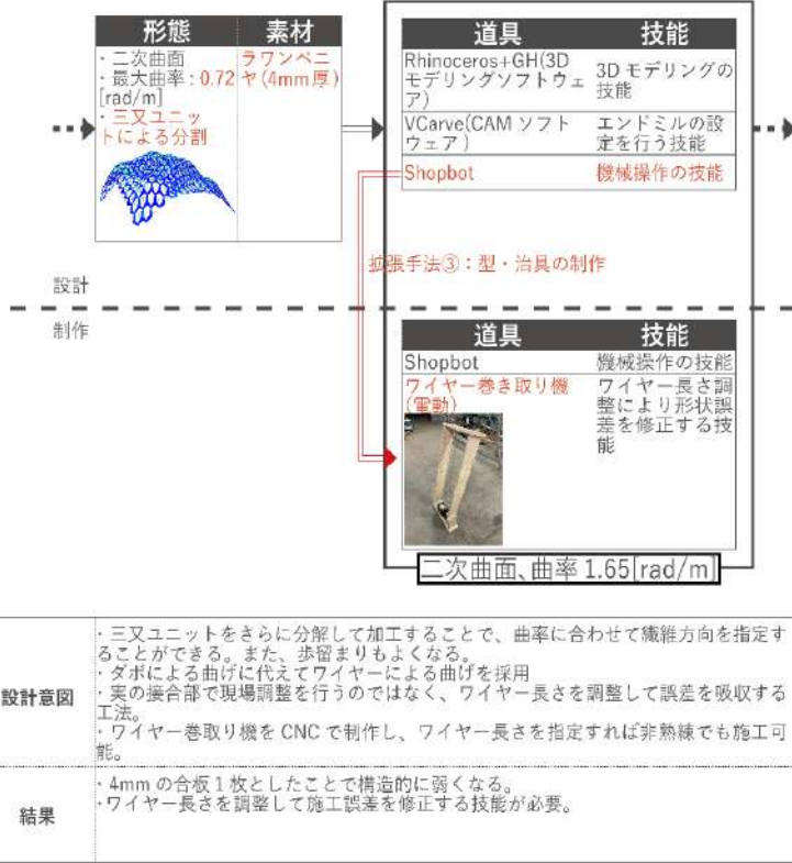
図 69 設計・制作プロセス（形態: 三又ユニット分割による最大曲率 0.72 [rad/m]の二次曲面/ 素材: ラワンベニヤ (4mm) / 道具: ワイヤー+ワイヤー巻き取り機）
