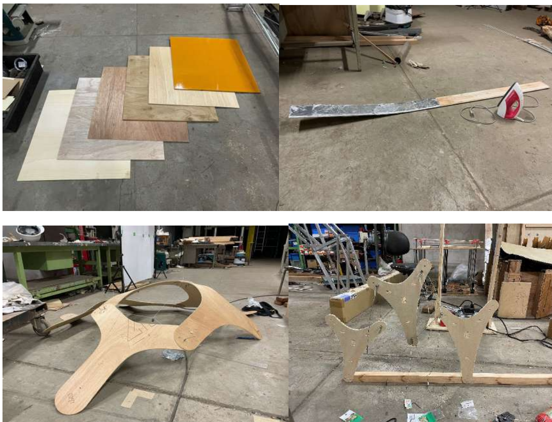
様々な合板、フローリングの熱曲げ、三又パネルのワイヤーによる曲げ、三又パネルのテンセグリティによる曲げ
