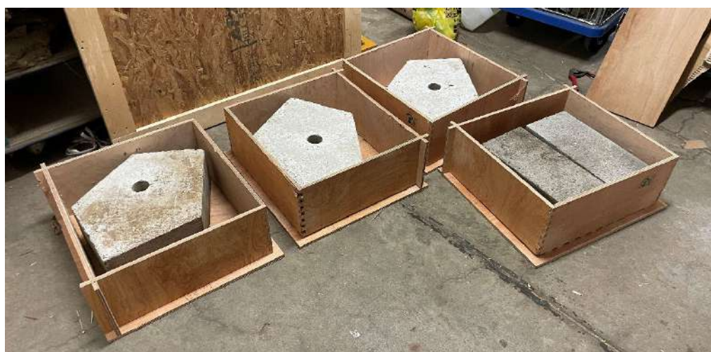
図 90 構造物の足元部分の制作
