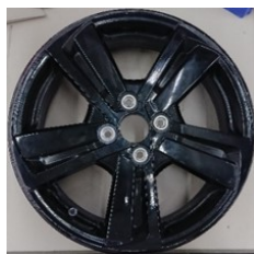
(a) CFRP ホイール (チョップド糸, 17 インチ)
