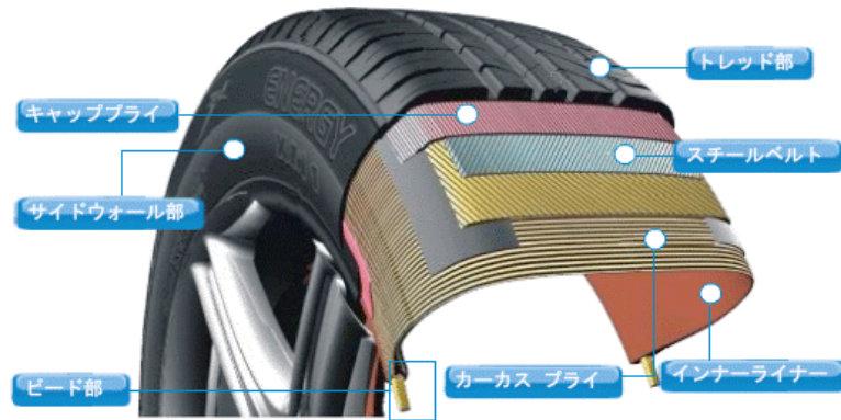
Fig. 11: タイヤの構造 [43]
