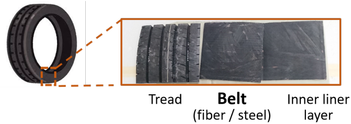
Fig. 21: ベルトの外観 (160×160 mm)
