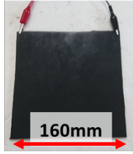
Fig. 20: タイヤゴムの電気伝導率測定
