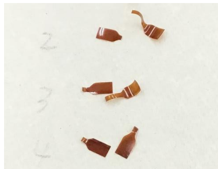
Fig. 47. ガラス転移点( T_g )より低い65°Cでの含水において軟化変形したサンプル
