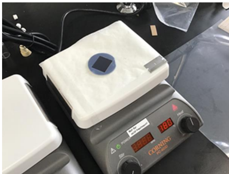
Fig. 59. QENS 用サンプルの作製で使したモールド
