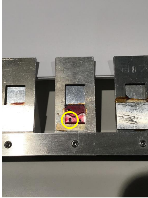
Fig. 87. 三次元水分量グラフにおいて一気に水分量が増えた領域に気泡が存在した。(黄色○印)
