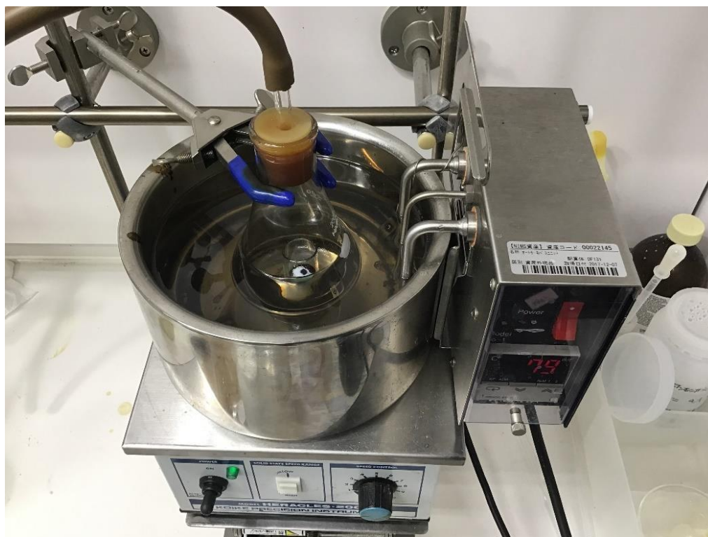
Fig. 37. オイルバスを用いた原料化合物の脱気の様子
