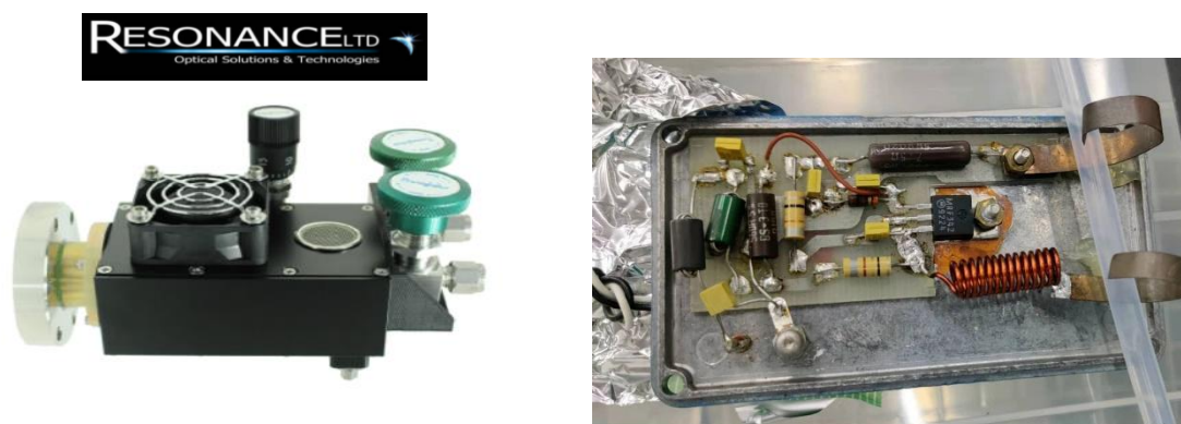
図 3.2. Resonance が販売している ICP 光源の外観図 (上) と内蔵する回路 (下) (Resonance, 2021)
