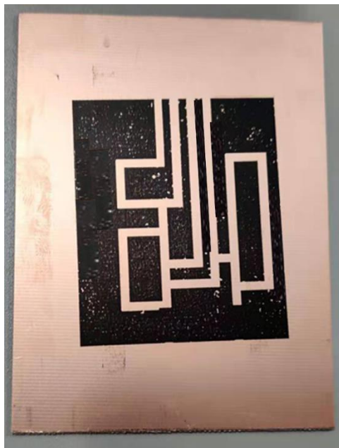
図 3.13. インクを銅張積層板に転写する様子
