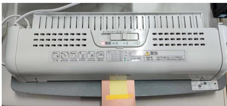
図 3.12. 熱転写紙を銅張積層板に貼り付け、熱転写プリンターに入れる。
