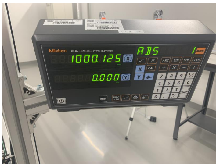
図 2.11 線源と線量計の距離を表示する座標パネル
