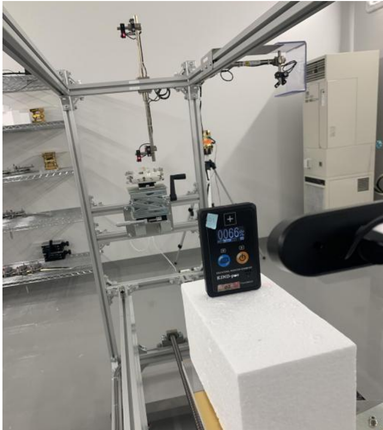
図 4.8 縦方向の方向特性試験の様子
