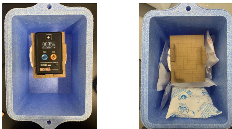
図 4.2 自作恒温箱の構造
