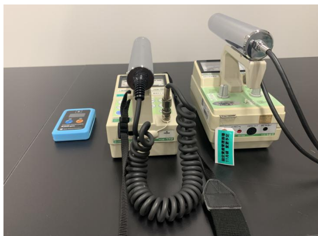
図 2.5 KINDpro と NaI シンチレーション線量計の外観比較
