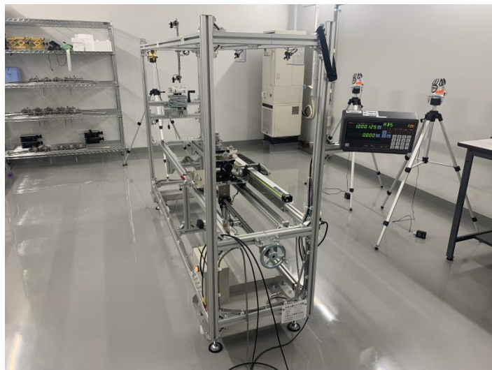
図 2.10 低線量校正室内で使用している校正台
