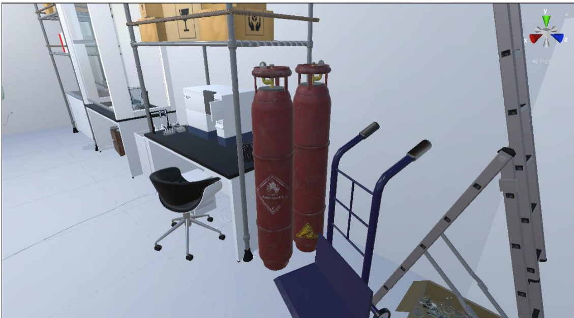
図 3.20 固定していないボンベ
