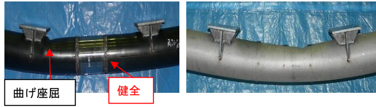
写真-5.1.3 鋼管φ190.7mm 単調曲げ試験後の状況
