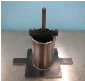
a) 杭先端部材あり (打設前)
