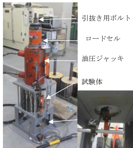
写真-3.1.1 附着強度試験状況 (タイプ1)
