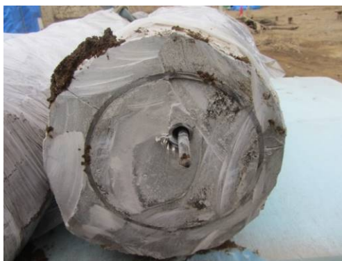
写真-3.8.1 断面方向に切断した試験杭
