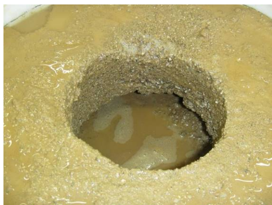
写真-3.9.7 孔壁崩壊状況 (Case2)
