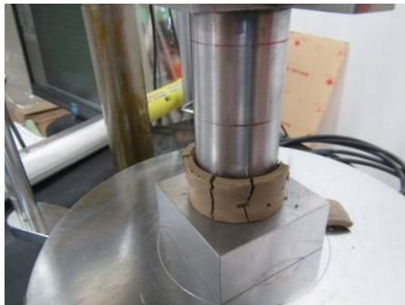
a) Case1 (杭先端部材なし)
