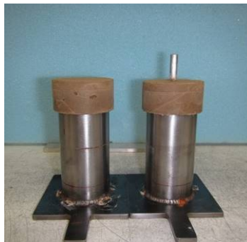
b) 固化体打設後 (粘性土系セメント改良土)
