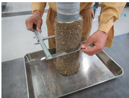
写真-3.9.4 出来形径計測状況 (Case1)
