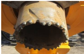
写真-2.3.1 ケーシング先端ビット
