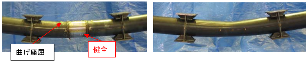
写真-5.2.2 鋼管φ190.7mm 正負交番曲げ試験後の状況
