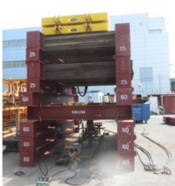
写真-4.1.1 実荷重ウエイト方式試験状況
