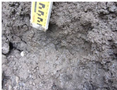
写真-3.10.2 地下水の発生状況
