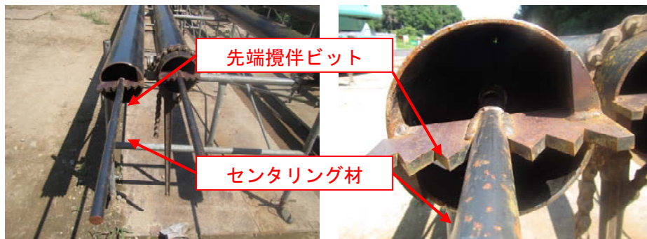
写真-2.3.3 先端攪伴ビットとセンタリング材
