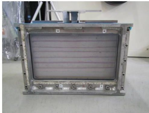
写真-3.4.3 模型地盤作製完了状況
