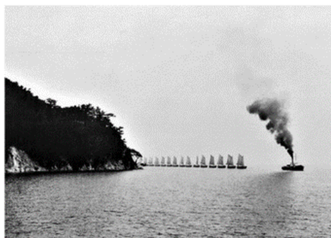
（図3-8）新居浜港から銅鉱石を製錬所のある四阪島に運搬するための「曳かれ船」
