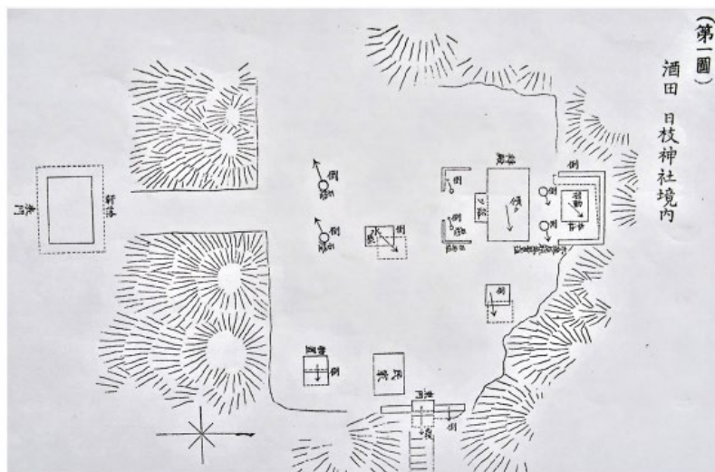
(図2-127) 日枝神社境内震災調査図 各建屋の傾き方向、倒壊方向を示す画面の右側が北
