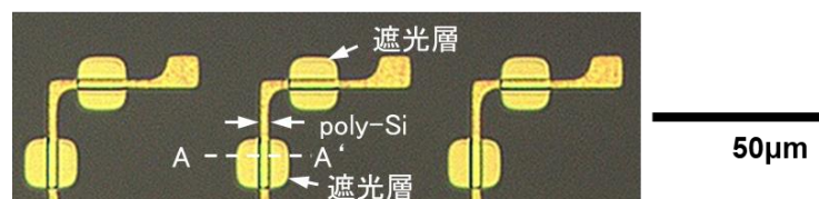
図 6-16 ガラス基板上に形成された遮光層と poly-Si
